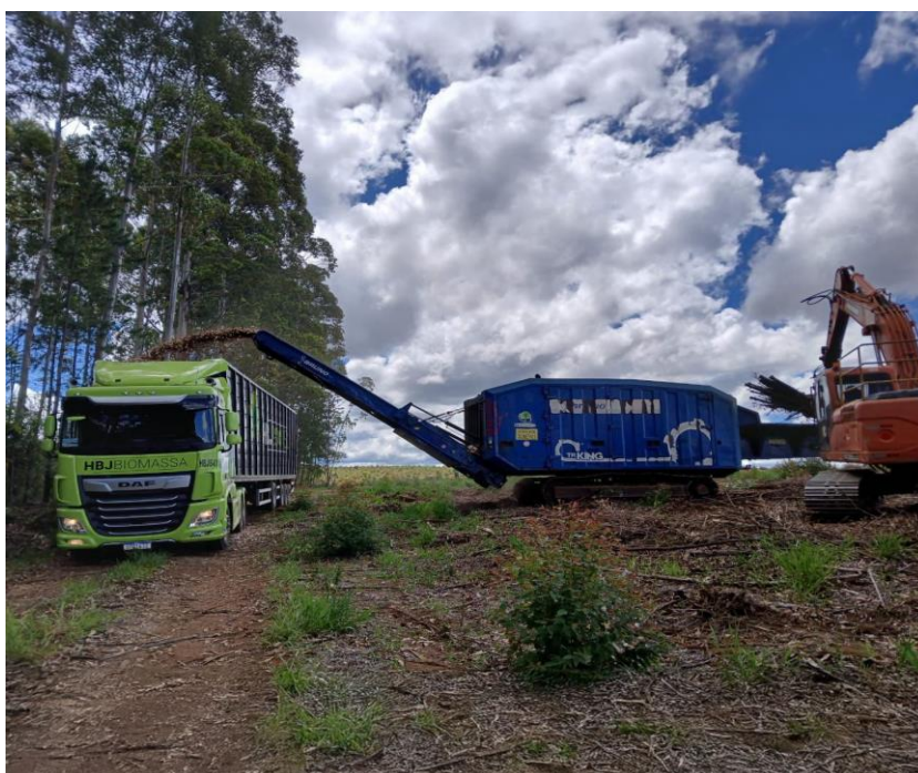
Figura 2: Maquinários móveis efetuando o processo de trituração.
