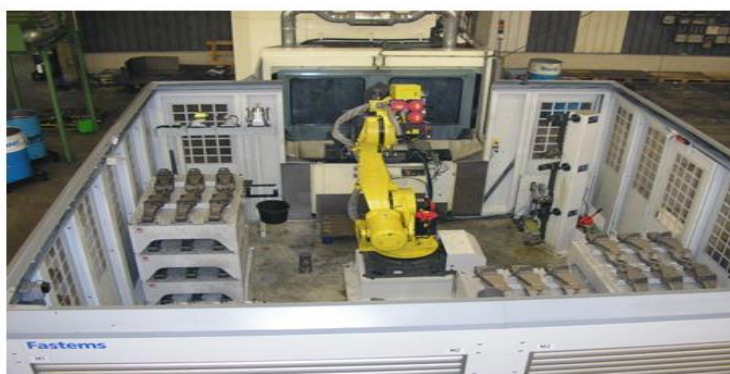
Figura 01 - Exemplo de célula de produção de um SFM
