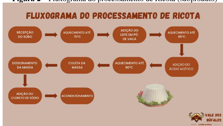
Figura 2 – Fluxograma do processamento de Ricota (subproduto)
